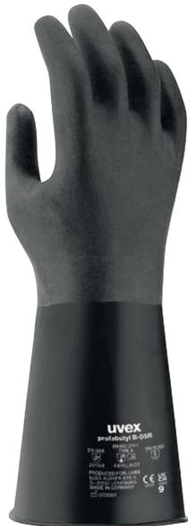
Aus 100 Prozent Butylkautschuk gefertigt eignen sich uvex profabutyl Chemikalienschutzhandschuhe vor allem für den Umgang mit polaren Verbindungen wie Ester oder Ketone.
