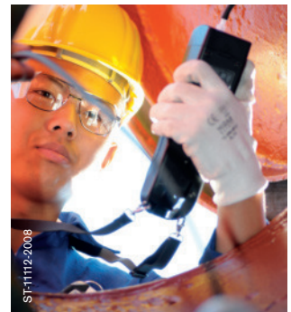
Dräger X-am 5000 Optionale externe Pumpe für Freigabemessungen
