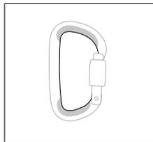
• Kontrollieren Sie Abnutzungserscheinungen, die vom durchlaufenden Seil oder durch Aufliegen an Anschlagpunkten verursacht wurden (Materialabtrag: Eine Abnutzung von mehr als 1 mm ist gravierend, Auftreten von scharfen Kanten usw.).
