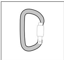
• Überprüfen Sie den Zustand des Körpers (Kratzer, Risse, Abnutzung, Verformung, Korrosionserscheinungen usw.).
