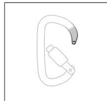
• Überprüfen Sie den Zustand der Nase (Kratzer, Abnutzung, Risse, Verformung usw.).
