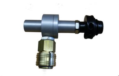
Dazu den Vakuüm-Adapter (schwarzer Befüllanschluss) in das Entlüftungsventil eindrehen (nicht in die Messing-Kupplung). Schnellschlusskupplung am Anschlussschlauch des Druckminde-
