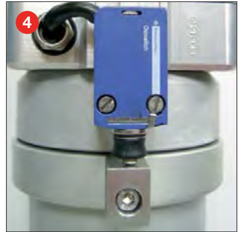
4 Standard angebauter und verkabelter Mastausfahrwarnschalter
