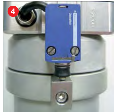
4 Standard angebauter und verkabelter Mastausfahrwarnschalter
