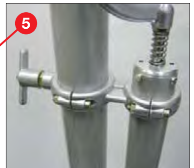
Handpumpe und Knebelschraube für schnelle und einfache Befestigung am Dreibeinstativ oder Fahrzeug-Anbauset
