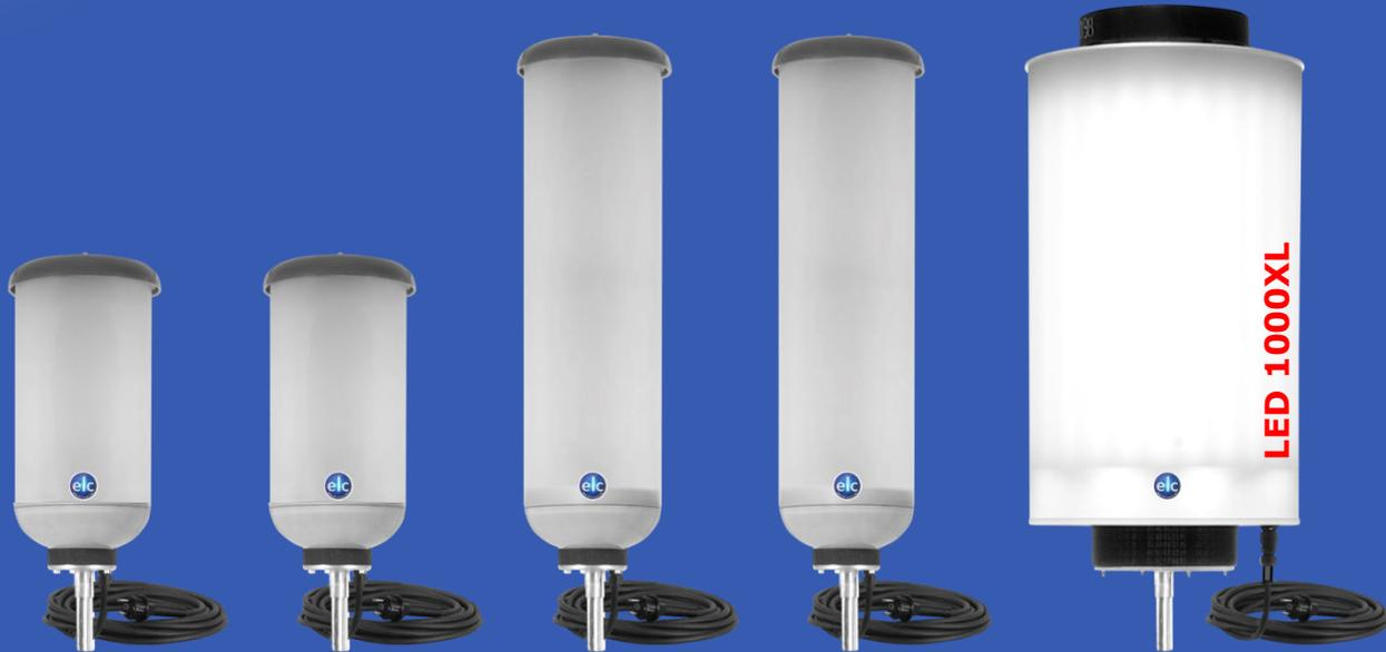
Der **LUMAPHORE® LED 1000XL** ist der zweitstärkste in der LUMAPHORE® LED-Produktreihe. Er ist mit **24 LED Modulen** ausgestattet. Um die Bodenbeleuchtung zu erhöhen, wurden **8 leistungsstarke COB LEDs** hinzugefügt. Standardversion mit EIN/AUS-Schalter und der Möglichkeit nur 180° zu beleuchten.
