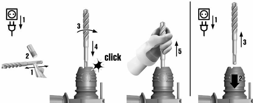
► Setzen Sie das Werkzeug ein /nehmen Sie das Werkzeug heraus.
