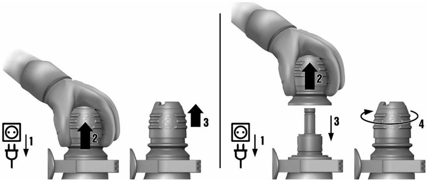
► Montieren / demontieren Sie die Werkzeugaufnahme.
