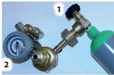
Zum Befüllen des Super-Mini-Hebekissens das Ventil der Druckluftflasche (1) langsam durch Linksdrehen öffnen. Dabei die Last und das Manometer (2) ständig beobachten. Der momentane Betriebsdruck im Kissen wird auf dem Manometer angezeigt.
