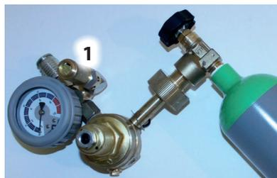
Zum Entleeren des Super-Mini-Hebekissens und/oder zum Absenken der Last die Ablassvorrichtung am Kopf des Sicherheitsventils (1) durch Linksdrehen öffnen.
