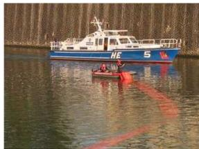
Der Doppelkammerschlauch kann fertig montiert im Wasser verlegt werden und dann mit einem starken Gebläse gefüllt werden. Dabei sind die Strömung zu beachten.
