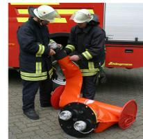
3. Der große Stutzen wird zunächst mit einem kurzen Zurrurt ( 1,40) befestigt.
