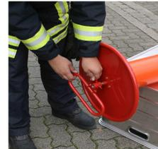
Haspel vor dem Schlauchwechsel sicher und etwas erhöht lagern. Das erleichtert das Wechseln.
