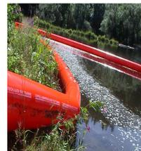
Grundsätzlich sollte nur die tatsächlich benötigte Länge der Ölsperre in ein Gewässer eingebracht werden. Der Doppelkammerschlauch wird hierfür vor Ort auf die erforderliche Länge zugeschnitten oder ist schon fertig eingebunden.
