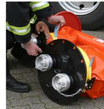
Bei korrekter Anbringung der Zurrurte halten die Einfüllstutzen eine Zugbelastung bis zu drei Tonnen aus. Die Einbindung ist bei sachgerechter Handhabung nahezu gas- und flüssigkeitsdicht.
