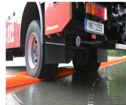
Herabhängende Schneeketten (Schleuderketten) können beim Überfahren das Schlauchmaterial beschädigen. Eine Beschädigung des Schlauches durch Auspuffteile ist ebenso denkbar.
