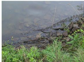
Die Sperre hat noch keine Eintauchtiefe und keinen Strömungswiderstand. Bei starkem Wind, kann die nur mit Luft gefüllte Ölsperre während des in Stellung bringen, vorübergehend noch von der Wasseroberfläche abheben, allerdings nur so lange bis der kleine Schlauch mit Wasser gefüllt ist.
