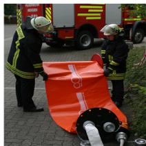
Von Hand Abziehen und gleichzeitig befüllen
