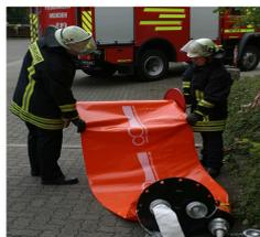
Den Doppelkammerschlauch schon während des Ausrollens mit Flüssigkeit befüllen dadurch wird dieser am Boden fest fixiert
