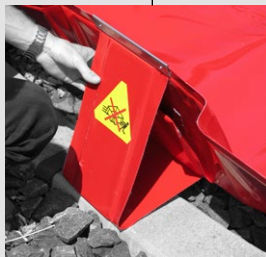
Richtige Verankerung der Seitenstützen
