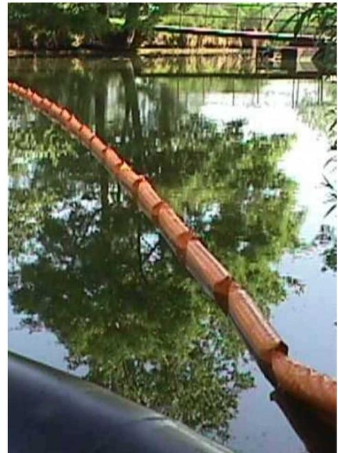
Auftrieb und Formstabilität erhält die Ölsperre 250 WDF/F über widerstandsfähige Kunststoffschwimmkörper und flexible Ausgleichsstücke.
