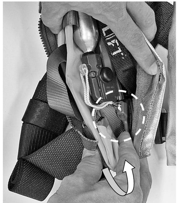
Nachdem die Faltung des Auftriebskörpers bis zum oberen Ende weiter geführt wurde, kann die Automatikseite mit der Klettbandlasche (gegenüber der „Sollbruchstelle/ Quickburst“) fixiert werden.
