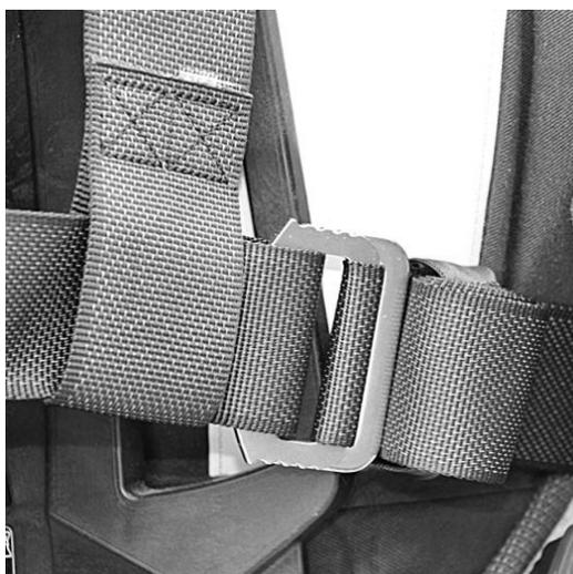
Oder man faltet größere Schlaufen und steckt diese dann in die am Brustgurt befindlichen Gurtbandlaschen. Die Schlaufen können dann auch mit dem Klettbandverschluss gesichert werden.
