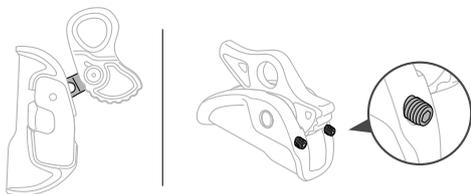
Überprüfen Sie den Zustand der Sicherheitssperren und dass die Rückholfeder einwandfrei funktioniert.
