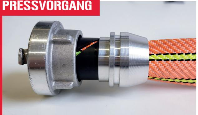
Der Außenring muss von Hand an dem Innenring angesetzt werden. Der Innenring muss genau in den Außenring passen.
