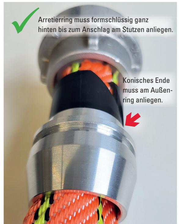
Arretierring muss formschlüssig ganz hinten bis zum Anschlag am Stutzen anliegen.
