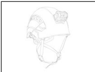
Das SLOT ADAPT-Befestigungssystem ermöglicht, eine mit einem VERTEX- oder STRATO-Helm kompatible Stirnlampe anzubringen.
