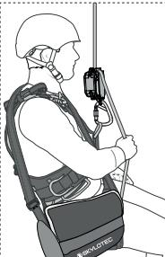
4 Rescue/descent with rope length <20m (with free-hanging rope)/ Rettung/Abfahren mit Seilstrecke <20m (mit frei hängendem Seil)
