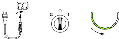
Das instagrid ONEmax befindet sich im Zustand LADEN, wenn der Drehschalter in Position 2 steht und der Ladeeingang mit dem Stromnetz verbunden ist. Die LEDs zeigen eine Fortschritts-Animation in grüner Farbe an. In diesem
