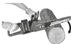
Die Kettensäge mit dem Krallenanschlag (5) gegen das Holz ansetzen und dann erst mit dem Sägen beginnen, indem man die Maschine am Bügelhandgriff (7) hält
