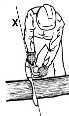
Der linke Arm sollte beim Durchsägen nahezu gestreckt sein. Die Maschine so führen, dass sich keine Körperteile außerhalb der gedachten Linie "X" - durch die Führungsschiene und in seiner Verlängerung - befinden.
