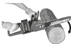
Die Kettensäge mit dem Krallenanschlag (5) gegen das Holz ansetzen und dann erst mit dem Sägen beginnen, indem man die Maschine am Bügelhandgriff (7) hält und den Schalterhandgriff (14) hochzieht.
