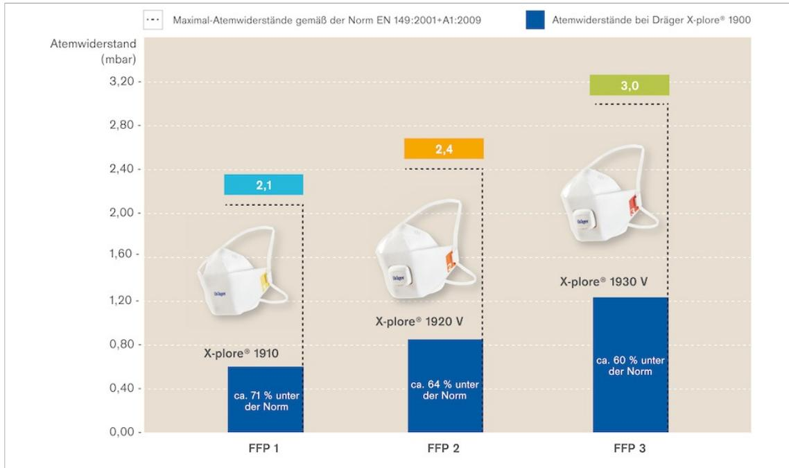
\* Alle Werte für Einatmung bei 95 l/min. Die dargestellten Werte sind durchschnittliche Werte der Dräger X-plore® 1900 Varianten in Größe M/L basierend auf Dräger internen Prüfergebnissen gemessen nach den Anforderungen der EN 149:2001+A1:2009.
