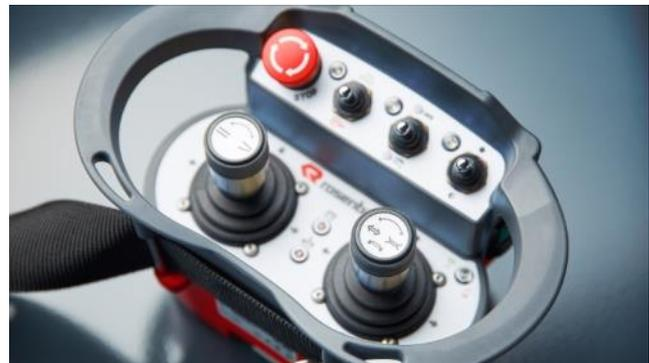
T3 mit 2 Joysticks - für Roboter und z.B. Wasserwerfer
