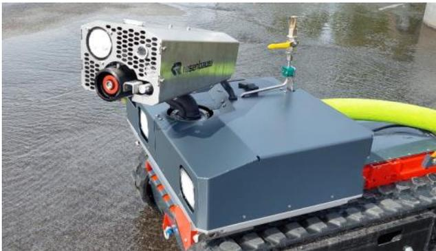
CC81G - Modul RM15C (bis 2.000 l/min bei 10 bar)
