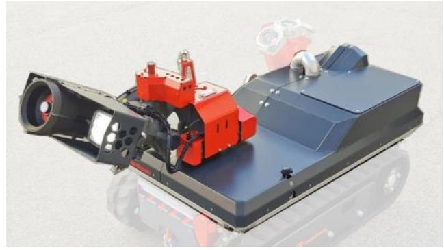
CC81J - Modul RM35C (bis 3.800 l/min bei 10 bar)
