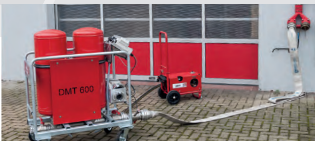
• Durchflussmessgerät DMT 600 im Einsatz.
