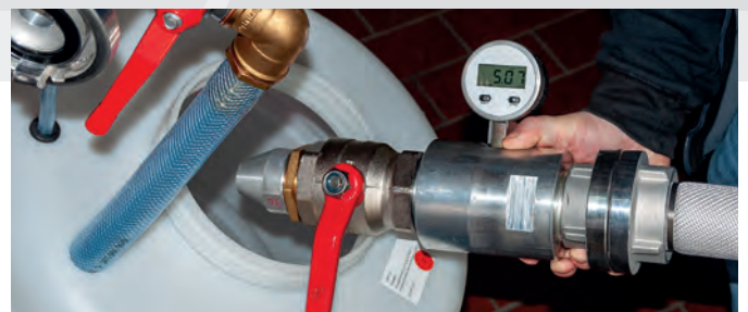
• Hydrantenprüfset HPS 2.0 im Einsatz.
