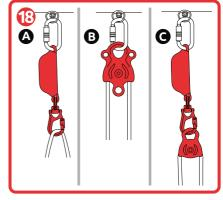
Beim Ausfahren des Leitersystems ist darauf zu achten, dass der Entriegelungsmechanismus der Abseilvorrichtung DRUID betätigt wird und das Seil frei laufen kann. Wie unter Punkt 4 beschrieben, kann ein zweites Set verwendet werden, um eine redundante Sicherung einzurichten. Die maximale Gesamtlast darf bei einer Rettung 200 kg nicht überschreiten.
