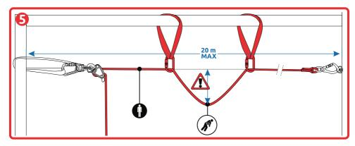
Ein zweites C.S.R. SET kann (**Abb.1b**) an diesem horizontal gespannten Seil installiert werden (**Abb.6**).
