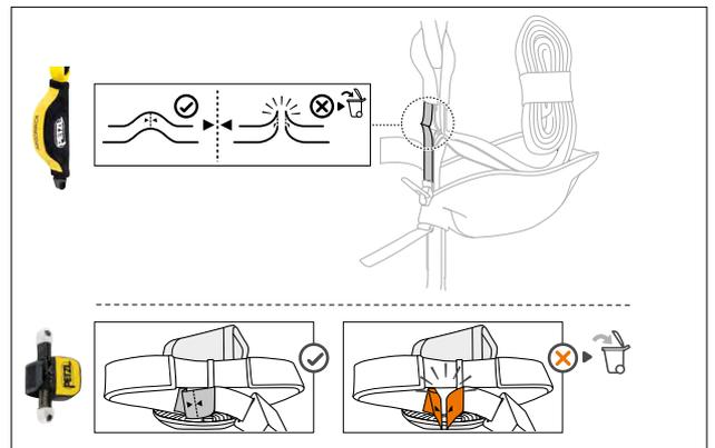
Vergewissern Sie sich, dass der Falldämpfer keinen Schlag oder Stoß erlitten hat (Stellen Sie sicher, dass das Gewebe zwischen den Gurtbändern nicht aufgerissen ist).
