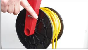
Arretierung an der Trommel lösen und die Leitung ganz oder soweit abrollen, dass die Prüfstelle von der Erdungsstelle aus bequem zu erreichen ist.
