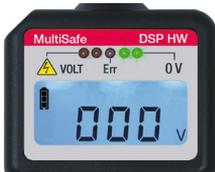
*Geprüfter Gegenstand hat aktuell Erdpotential und keine Spannung.*
