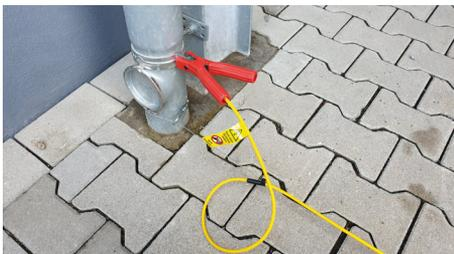
Erdung am Fallrohr
