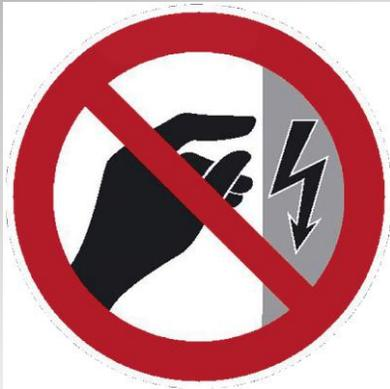
Die Klemme für den Erdanschluss kann während der Prüfung unter Spannung stehen! Die Gefahr eines Stromschlags wird durch die Schutzelemente im Gerät verhindert.
