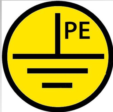
Vor Prüfungen auf Spannungsfreiheit muss die Leitung an einen Erder angeschlossen und gegen versehentliches Abziehen gesichert werden...
