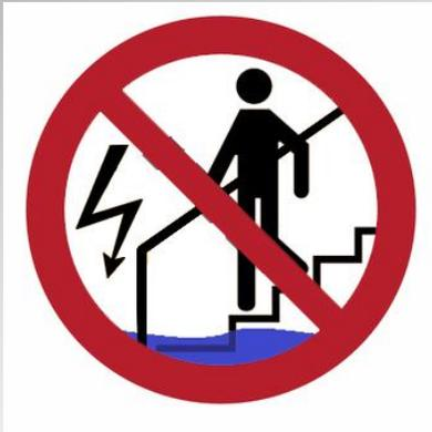
Wasser und in das Wasser ragende Teile (z.B. Geländer) nicht berühren! Diese Teile können unter Spannung stehen! Auch nach festgestellter Spannungsfreiheit Wasser nicht berühren! Durch sich ändernde Pegelstände können jederzeit Gefahren auftreten..
