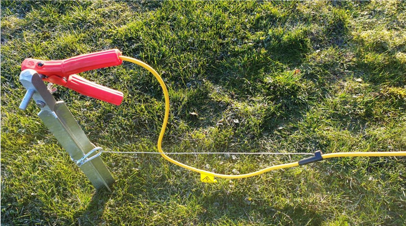
Zur Sicherung der Klemme gegen versehentliches Abziehen muss das Sicherungsseil um einen Erdungsspieß, Träger oder Mast befestigt werden.
