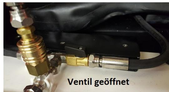
5. Öffnen Sie das Hauptventil der Pressluftflasche. Der Füllvorgang der Hauptkammern und des Luftbodens startet nun.
