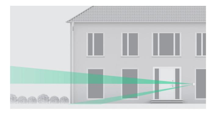
Der DualCurtain Outdoor besitzt zwei Bewegungssensoren, die in entgegengesetzte Richtungen zeigen. Der Erfassungsbereich wird für jede Seite einzeln mit den Schiebereglern Detection distance auf der Rückseite des Melders eingestellt.
