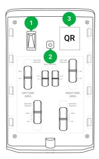
**1.** Manipulationsschalter: wird ausgelöst, sobald der Melder aus der Halterung genommen oder abgerissen wird
