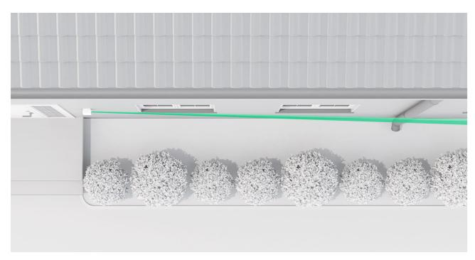
Aktivieren Sie ggf. die **Nahbereichserkennung** (Schieberegler **Near area detection**) für eine gewünschte Seite. Diese Funktion reduziert den blinden Fleck des Melders und ermöglicht daher die Bewegungserkennung von Eindringlingen, die den geschützten Bereich unmittelbar am Melder betreten.
