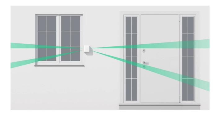
Wenn eine Seite des Melders zum Schutz einer Tür und die andere zum Schutz eines Fensters eingesetzt wird, muss der Melder ebenfalls in einer Höhe von 0,5 – 0,6 Metern über der Fensterbank angebracht werden. Wenn der Melder in der Nähe des Fensters installiert wird, muss die Funktion Nahbereichserkennung aktiviert werden (Schalter Near Area Detection auf der Rückseite des Melders). Diese Funktion verkleinert den blinden Fleck im Nahbereich des Melders.
