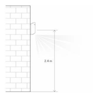
Die Installation des Melders in einer anderen als der empfohlenen Höhe verengt die Erfassungszone und kann die Qualität der Bewegungserkennung beeinträchtigen. Denken Sie daran, dass MotionProtect Curtain keine Bewegung hinter dem Glas erkennt. Installieren Sie den Melder daher nicht an Orten, an denen Glaskonstruktionen die Sicht einschränken können, z. B. an Orten, an denen ein offenes Fenster den Blickwinkel des Geräts einschränken kann.
