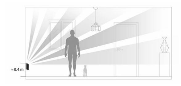
Der Montageort des MotionProtect Curtain hängt vom Abstand zur Hub-Zentrale und von Hindernissen zwischen den Geräten ab, die das Funksignal stören können: Wände, Böden, massive Gegenstände im Raum.
