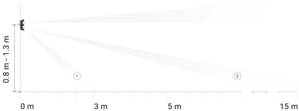
3. Setzen Sie MotionProtect Outdoor auf die SmartBracket-Befestigungsplatte. Verlassen Sie den Erfassungsbereich des Melders (horizontaler Erfassungswinkel 90°) und stellen Sie sicher, dass keine Bewegungen innerhalb des Erfassungsbereichs stattfinden, um die Kalibrierung der Abdecksensoren zu ermöglichen.
