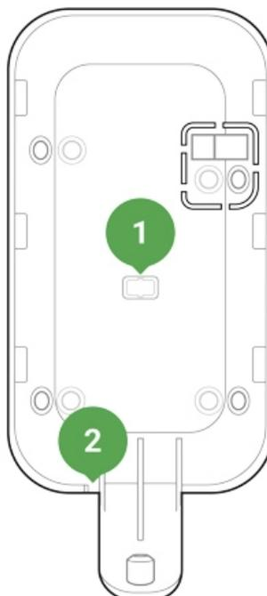
1. Für den Stromversorgungskabelausgang hinter der SmartBracket-Befestigungsplatte
