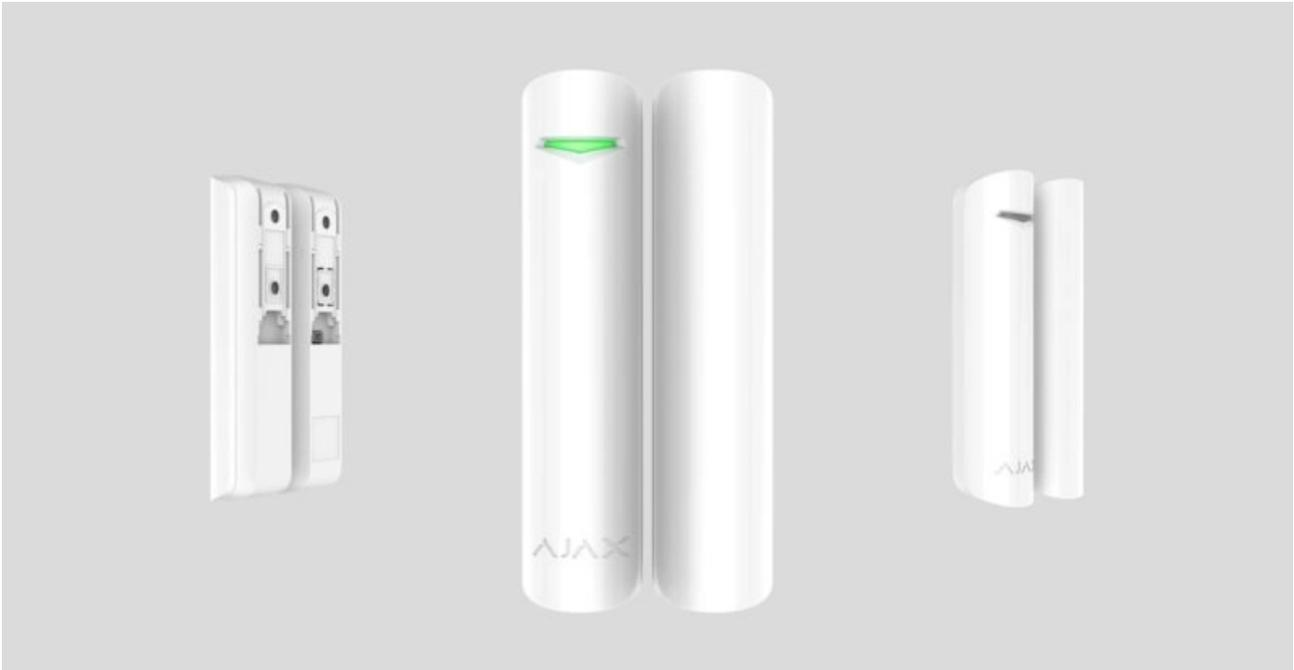
DoorProtect Plus ist ein drahtloser Öffnungs-, Schock- und Neigungsmelder, der innerhalb des Ajax-Sicherheitssystems arbeitet und über das geschützte Jeweller-Funkprotokoll verbunden ist. Verwendung in Innenräumen. Die Kommunikationsreichweite beträgt bis zu 1.200 m Sichtlinie. DoorProtect Plus kann mit einer vorinstallierten Batterie bis zu 5 Jahre betrieben werden und kann mehr als 2 Millionen Öffnungen erkennen.
