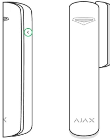
Wenn der Melder in den senkrechten Ebenen (innerhalb des Gehäuses/Rahmens) installiert wird, verwenden Sie den kleinen Magneten aus dem Set. Der Abstand zwischen Magnet und Melder sollte 1 cm nicht überschreiten.
