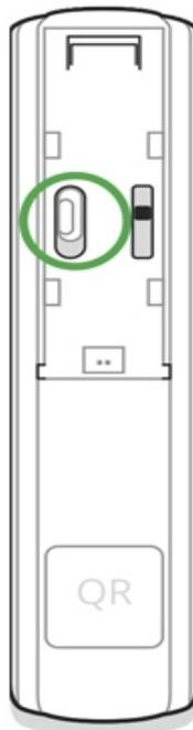
Damit Erkennung und Verbindung erfolgen kann, muss sich das Melder im Empfangsbereich des drahtlosen Netzwerks der Hub-Zentrale befinden (an einem einzelnen geschützten Objekt). Die Verbindungsanfrage wird im Moment des Einschaltens des Geräts für kurze Zeit übertragen.
