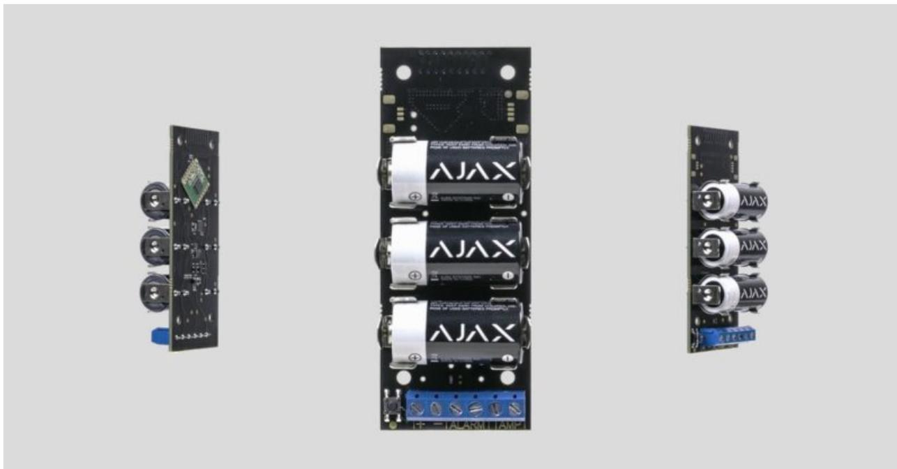
**Transmitter** ist ein Modul zum Anschließen von Sensoren von Drittherstellern an das Sicherheitssystem „Ajax“. Er gibt Alarm und spricht auf den Sabotagekontakt des externen Sensors an. Er ist mit eigenem Beschleunigungsmesser ausgestattet, der gegen Entwendung schützt. Er wird von Batterien betrieben und kann auch den angeschlossenen Sensor mit Strom versorgen. Die Reichweite des Moduls beträgt, ohne Hindernisse, bis zu 1600 m (ohne Gehäuse).
