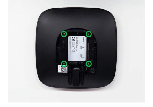
**5.** Entfernen Sie die Schrauben, mit denen die Platinen am Gerätegehäuse befestigt sind.
