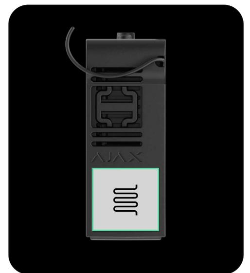
Aufkleber, der angibt, welches Gerät oder welchen Stromkreis das Relais steuert.
