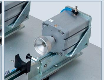
• Spezieller Pneumatik-Spanner.
