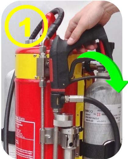
Öffnen sie das Flaschenventil vollständig. Ein heulender Ton im Behälter signalisiert den Druckaufbau.
