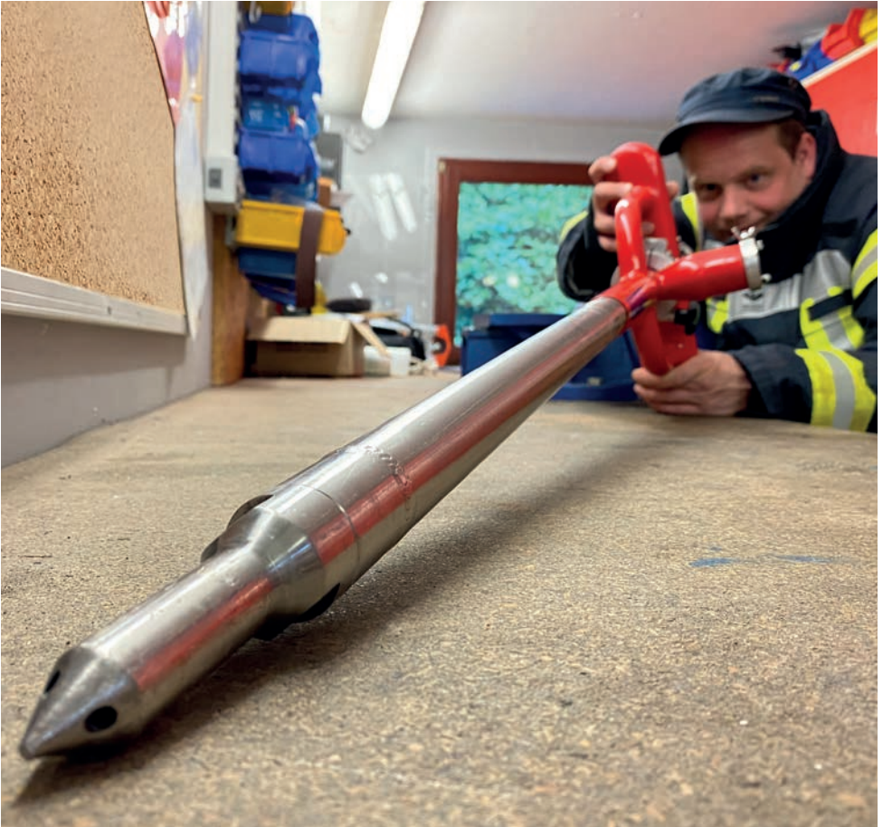
I Abbildung 17 Sichtprüfung – E-Löschlanze® auf Verschleiß
