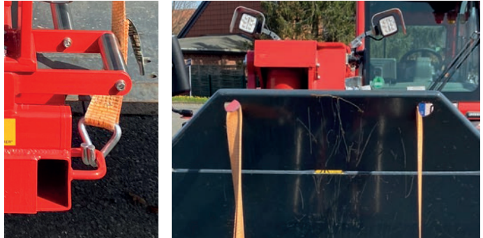
I Abbildung 14 Sicherung bei Einsatz mit Sand-/Baggerschaufel
