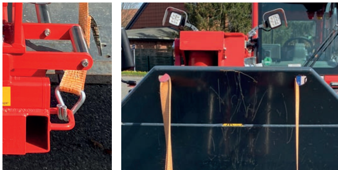
I Abbildung 12 Sicherung bei Einsatz mit Gablezinke
