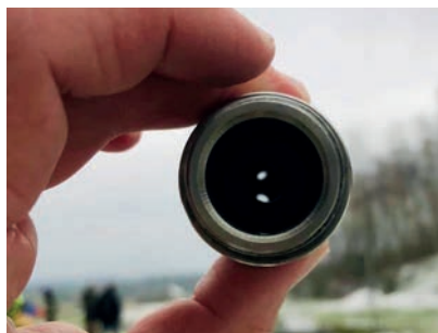
I Abbildung 16 Sichtprüfung – Durchgängigkeit der E-Löschlanzenspitze
