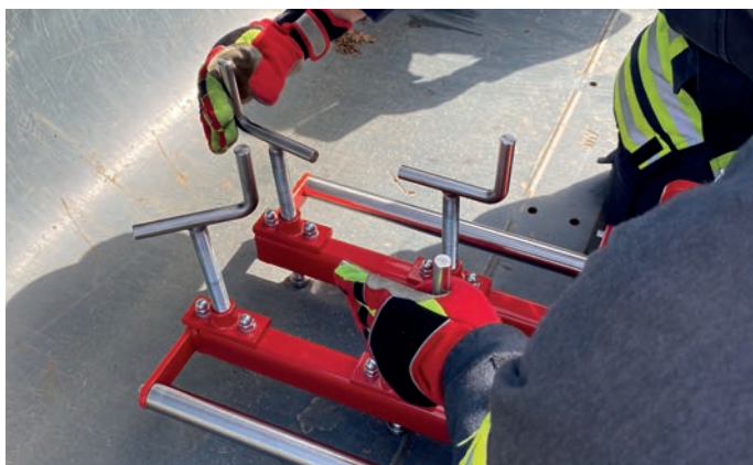
I Afbeelding 13 Gebruik met een zandschop/graafbak
