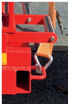
I Afbeelding 14 Borging bij gebruik met zandschop/graafbak
