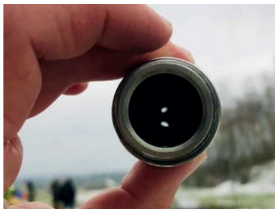
I Afbeelding 16 Visuele inspectie – is E-bluslanspunt nog open?
