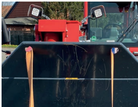
I Afbeelding 12 Borging bij gebruik met vorktand
