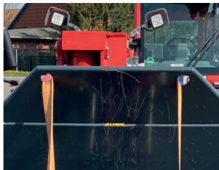
I Afbeelding 14 Borging bij gebruik met zandschop/graafbak
