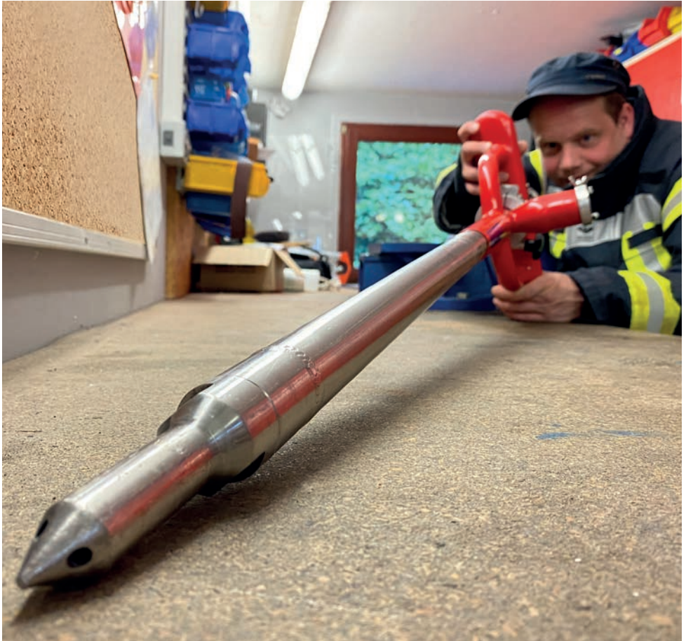
I Afbeelding 17 Visuele inspectie – E-bluslans (E-Löschlanze®) op slijtage
