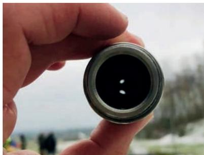
I Figura 16 Control visual: apertura de la punta de la E-Löschlanze®
