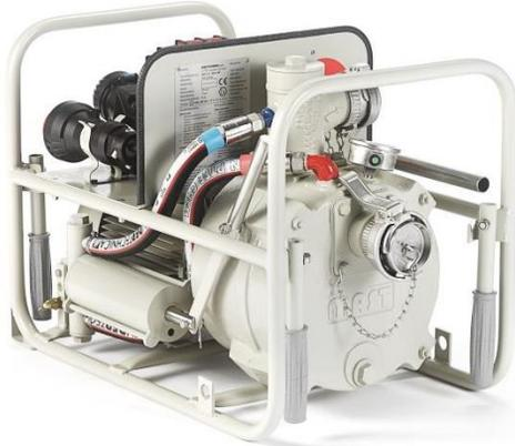
Besonders geeignet für grobkörnig verschmutzte Flüssigkeiten (z.B. mit Steinen, Glas, Metallstücke).
