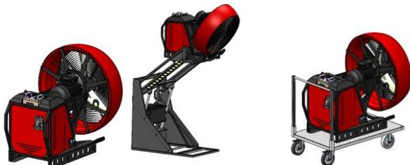
Der Großlüfter Easy e2000 ist von -30° bis +30° in der Neigung einstellbar und zudem mit einem integrierten Drehzahlregler ausgestattet. Über seinen 220V-Ausgang (einphasig, max. 10 A) können zusätzliche Geräte mit Strom versorgt werden. Dank Elektroantrieb ist auch der Wartungs- und Instandhaltungsaufwand überschaubar: So ist beispielsweise kein Ölwechsel erforderlich.
