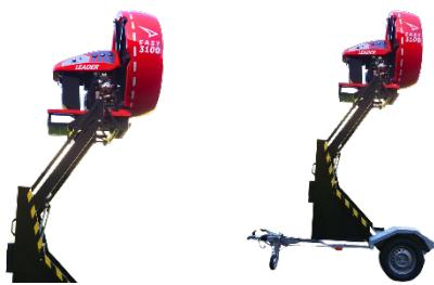
Der EASY 3100 ist eine kompakte, sehr effektive Lösung für die Entrauchung und Belüftung in großen Flächen (Parkhäuser, Hochhäuser, Produktionshallen, Lagerhallen, Messehallen usw.). Eine Kabelfernsteuerung ermöglicht die präzise Einstellung des Hubtischs (0–2 m), der Neigung (-20° bis +20°) sowie das Ein- und Ausschalten der beiden Beleuchtungsspot.
