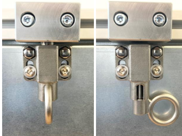
Abbildung 7: Verschluss in geschlossener/verriegelter (links) und offener (rechts) Position.
