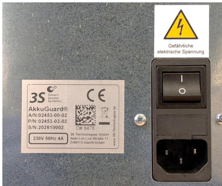
Abbildung 5: Position des Netzeingangsmoduls mit Kaltgerätebuchse, Sicherungsschublade sowie Hauptschalter an der Geräterückseite.
