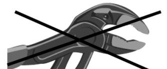
**Das Schlauchanschlussventil nicht am Oberteil festhalten oder festziehen, dieses könnte zu erheblichen Spannungen im Material führen, bis hin zum Riss. Das Schlauchanschlussventil immer im geöffneten Zustand montieren.**
