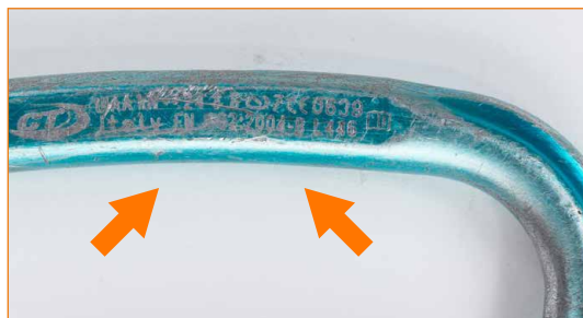
Conector con marcado no completamente legible.
