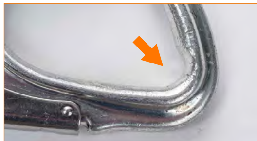
Cuerpo con evidentes signos de desgaste cerca de su área de deslizamiento sobre cable metálico.
