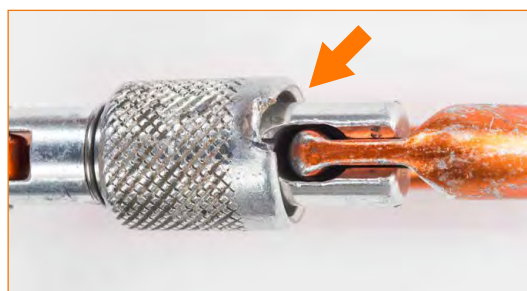
Connettore con ghiera a vite fortemente danneggiata.
