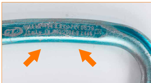
Connettore con marcatura non completamente leggibile.
