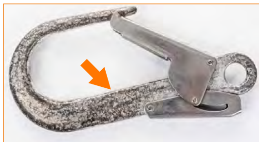
Conector de doble gatillo con evidentes signos de corrosión.
