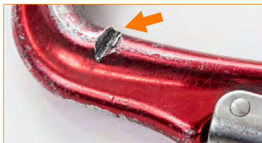
Conector con evidente rayadura cortante en el cuerpo.
