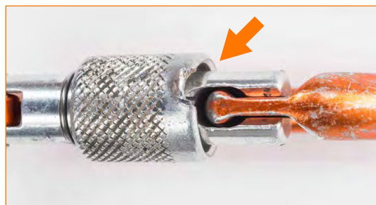
Verbindungselement mit stark beschädigtem Schraubverschluss.
