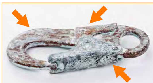
Conector de acero totalmente corroído debido a una prolongada exposición en ambiente salino.
