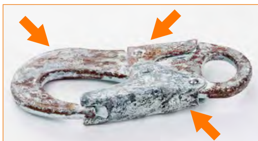
Connettore in acciaio interamente corroso a causa di lunga esposizione in ambiente salino.
