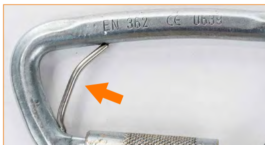
Verbindungselement mit verformtem Stäbchen.
