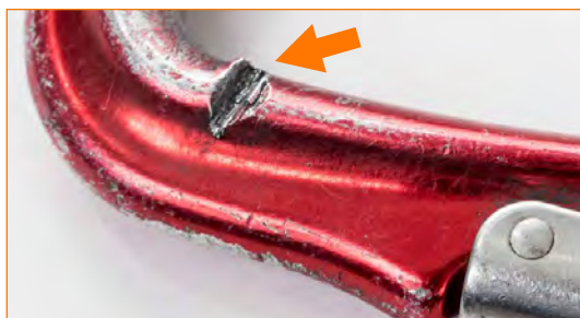
Connettore con evidente incisione tagliente sul corpo.
