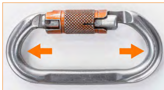
Connettore a ghiera estremamente deformato a causa di un'applicazione scorretta.
