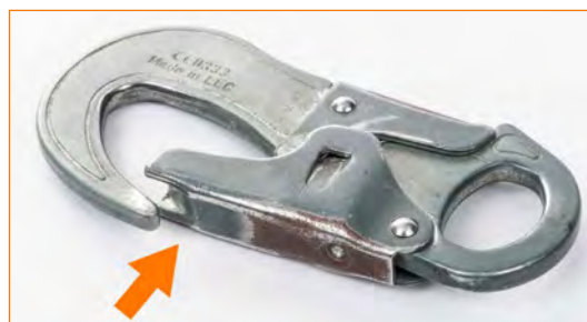
Connettore con ossidazione che ostacola la funzionalità delle leve di chiusura.
