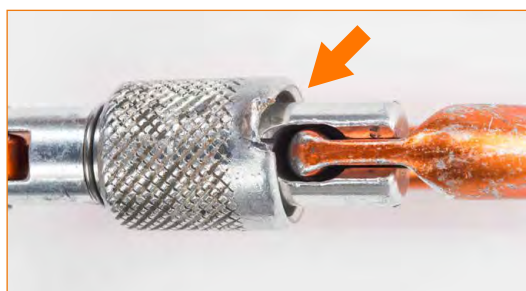
Conector con cierre de rosca muy dañado.
