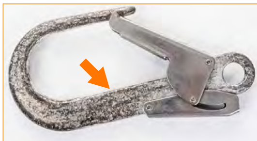
Connettore a doppia leva con evidenti segni di corrosione.
