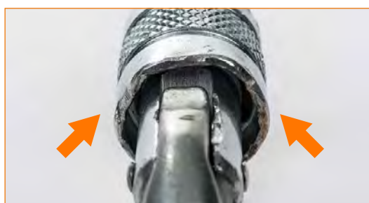
Conector con cierre de rosca extremadamente dañado.
