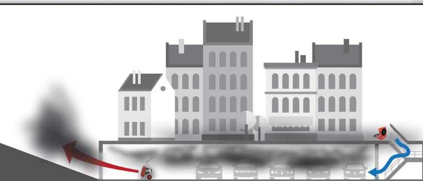
Im hier gezeigten Beispiel saugt der ParkFan 80 den Brandrauch aus dem Raum während der Angriffstrupp über das Treppenhaus in die Tiefgarage vorgeht. Um das Eindringen von Rauch in das Treppenhaus zu verhindern, sowie zusätzliche kühle Frischluft einzubringen, wird ein zusätzlicher Lüfter vor dem Treppenhaus platziert.
