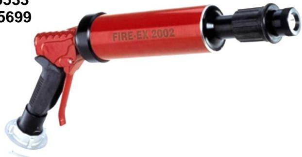
Das Fire - Ex ist ein wirksames Hilfsmittel zur Brandbekämpfung, mit dem Netzwasser hergestellt werden kann. In das Fire - Ex wird ein Seifenblock eingesetzt, welcher vom Wasser umspült und gleichmäßig beigemischt wird. Gewöhnliches Wasser dringt infolge seiner Oberflächenspannung nicht in alle Stoffe ein, sondern perlt mehr oder weniger stark ab. Eine Netzmittelbeigabe nimmt dem Wasser die Oberflächenspannung und erzeugt Tiefenwirkung. Brennende Gegenstände werden besser abgekühlt.
