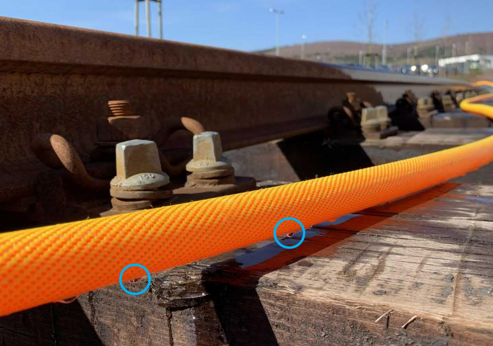
Selbstschutz des Waldbrandschlauchs WILDCAT vor Hitzeschäden, kontrollierter Wasseraustritt durch Perforierung der Schlauchwand
