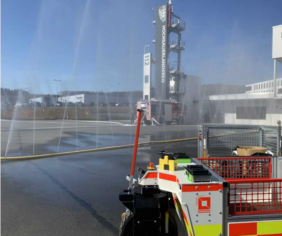
Erzeugung einer Wasserwand mithilfe von Iconos® Düsenschläuchen
