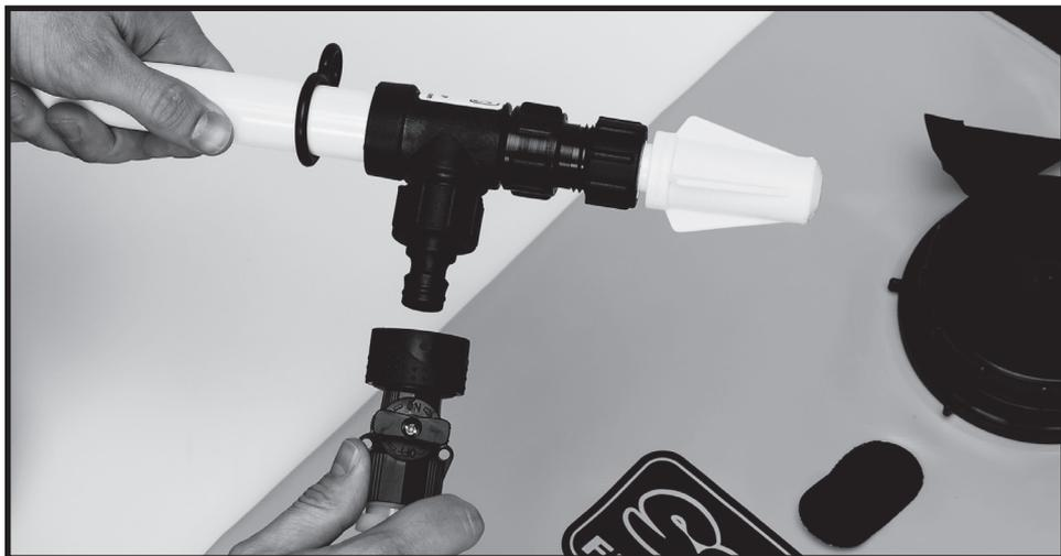
3. Stellen Sie sicher, dass das Ventil des Schnellkuppeladapters geschlossen ist (OFF Position).
