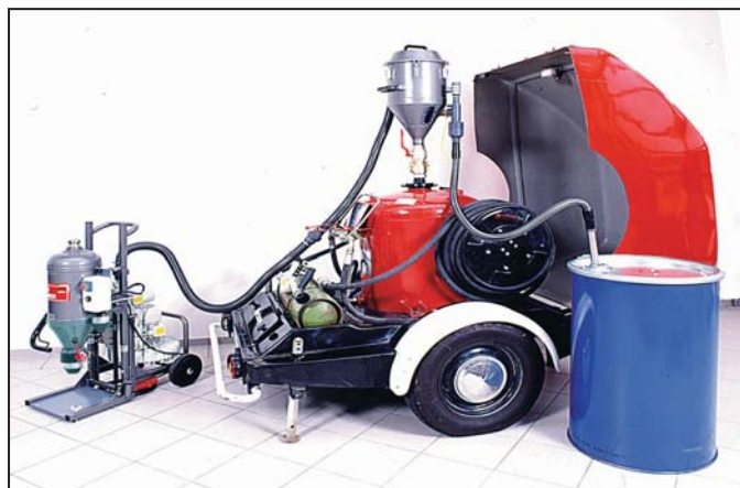
Bild 12: Beispiel für die Bearbeitung eines fahrbaren Feuerlöschers P 250.
