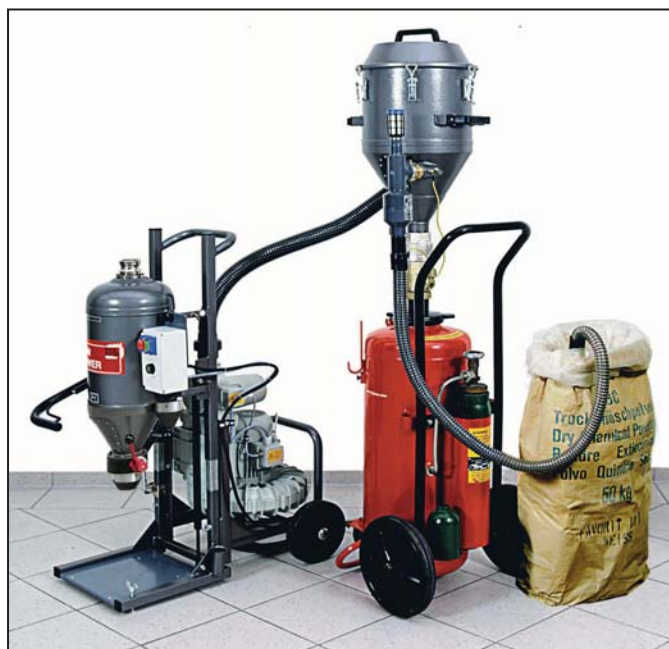
Bild 11: Durch Umsetzen des Filterkopfes auf den Feuerlöcher wird dieser, beispielsweise aus einem separaten Löschpulvergebinde, wieder gefüllt. Es wird also kein Set SK 50 benötigt.
